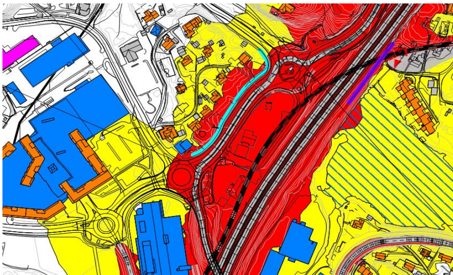
Figur 47: Samlet støynivå Lden fra veg og bane i utbygget situasjon ved Nyborg. Ny foreslått støyskjermer er vist i turkis. Beregningshøyde 4 m.o.t. Nord er opp i figuren.
